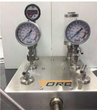
Calibramos mediante bomba comparadora de precisión, magnitudes de presión hidráulica hasta 1000 bar (15000 Psi) trazando mediante patrón calibrado por laboratorio INTI.
