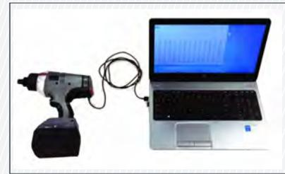
Descarga a PC por cable USB
