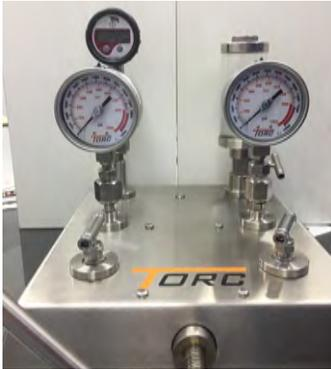
Calibramos mediante bomba comparadora de precisión, magnitudes de presión hidráulica hasta 1000 bar (15000 Psi) y presión neumática hasta 10 bar (145 Psi) trazando mediante patrón calibrado por laboratorio INTI
