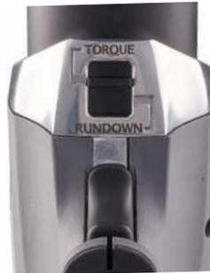
Con un simple interruptor, el T-BTM pasa del modo de reducción de velocidad de alta velocidad al modo de torque final preciso, eliminando la necesidad de múltiples sistemas en un trabajo. La caja de cambios mecanizada con precisión proporciona potencia constante sin la vibración y el ruido de las pistolas de impacto. Ajuste la potencia a través de la lectura digital en la parte posterior de la pistola para ajustar la salida de torque para cualquier trabajo.
